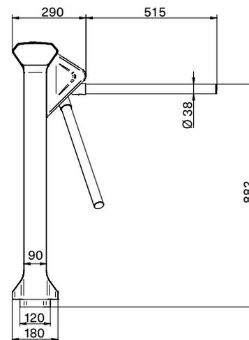
Spazio di montaggio per dispositivi di lettura per mTripod e mTripod corto (senza indicatore di passaggio, profondità di montaggio 40 mm)
