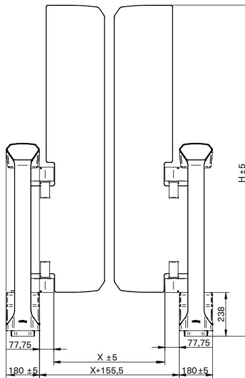
Spazio di montaggio per dispositivi di lettura (senza indicatore di passaggio opzionale, profondità di montaggio 40 mm)
