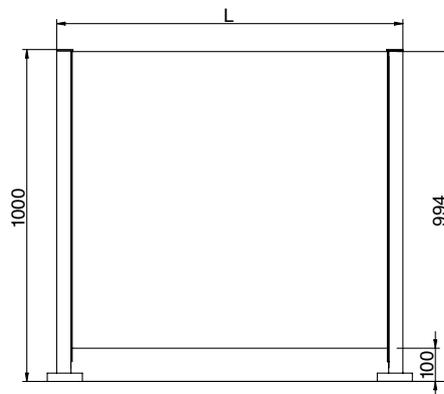
Configurazione della linea con mSwing, mTripod e mGuide come guida per l'utente ed elemento barriera
