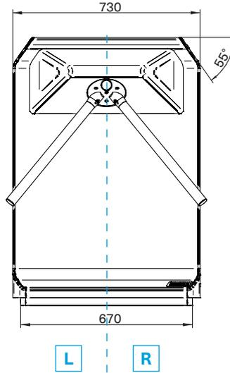
È possibile ottenere le opzioni per la versione sinistra **L** o destra **R**. Se osservi mTripod dalla punta della barra del tornello, l'opzione si trova a sinistra con la versione a sinistra e a destra con la versione a destra.
